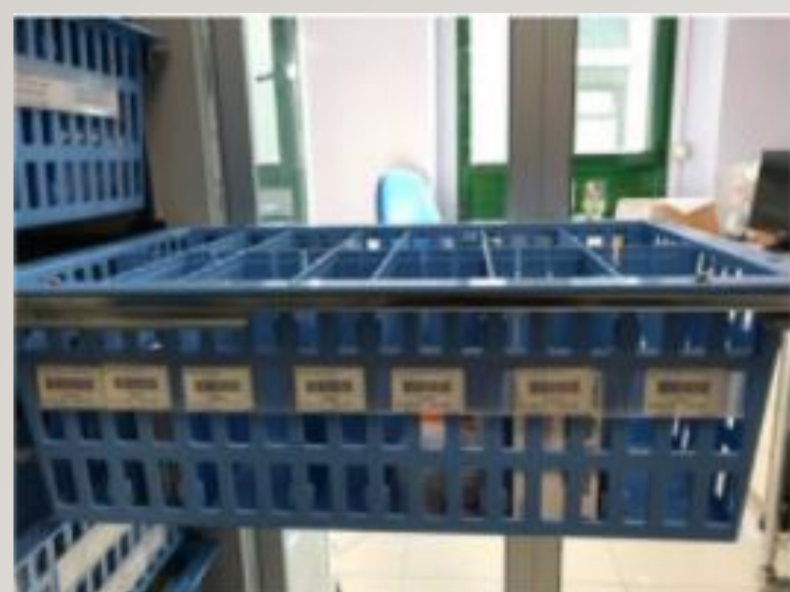
Figura 1. Il cassetto riporta frontalmente il nome commerciale dei farmaci ivi contenuti e ogni etichetta contiene una breve descrizione dell'articolo e il codice barcode relativo all'anagrafica.
